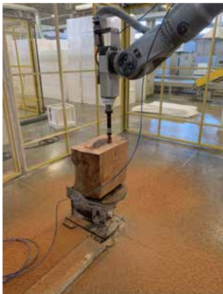
Découpe CNC 7 axes à partir d'une modélisation 3D
