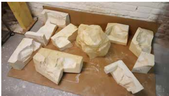
Fabrication moules plâtre (9 morceaux)
