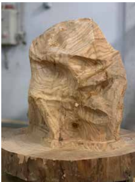
Découpe CNC 7 axes à partir d'une modélisation 3D
